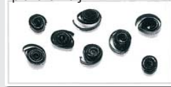
Καμμένα, βαριά γρέζια • Μειώστε την ταχύτητα καθόδου ή και την ταχύτητα της πριονοταινίας
